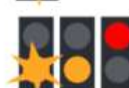
Az utat vagy egyes forgalmi sávokat keresztező villamos illetve a megkülönböztető jelzéseit használó gépjármű áthaladását biztosító fényjelző készülék
